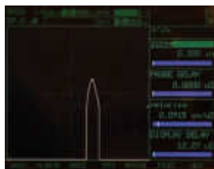
0.14" (3.6mm) 複合材の底面エコー
